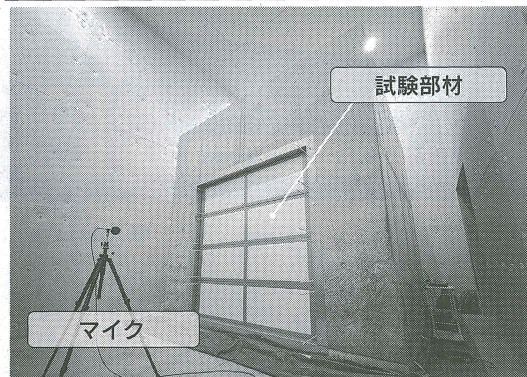
試験部材 マイク 自社研究所の半無響音室内に設置した残響室
