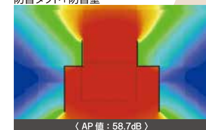
防音ダクト+防音壁
