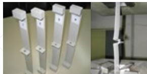
▶ビスの引き抜き強度試験
